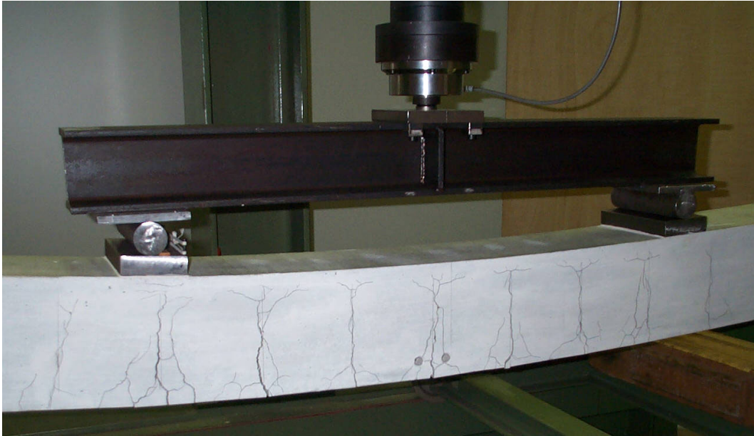
Bild 5.13 Kurzzzeitversuch (Balken 4), gleichmäßig verteilte Risse auch im Bereich der Montageeisen bei großer Durchbiegung
