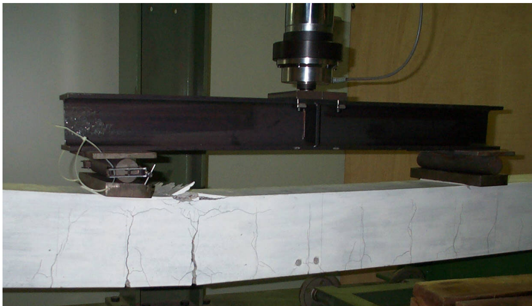
Bild 5.12 Langzeitversuch (Balken 3), ein großer Riss am Ende der Montageeisen bei kleinerer Durchbiegung
